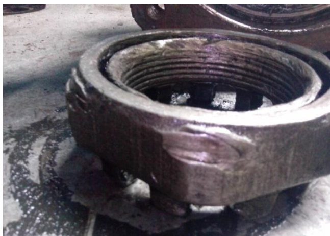
Рисунок А.14 – Зрив різі на гайці М110
