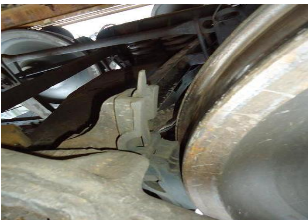
Рисунок А.29 – Відсутність гальмівної колодки
